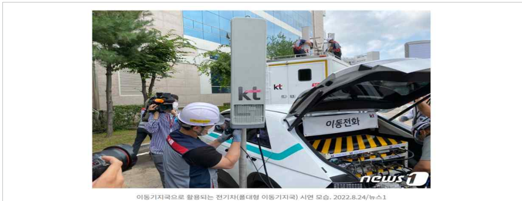
〈그림 3〉 AC 상용 전원 확보 어려운 재난·재해 환경에서 전기차를 활용한 이동 기지국
